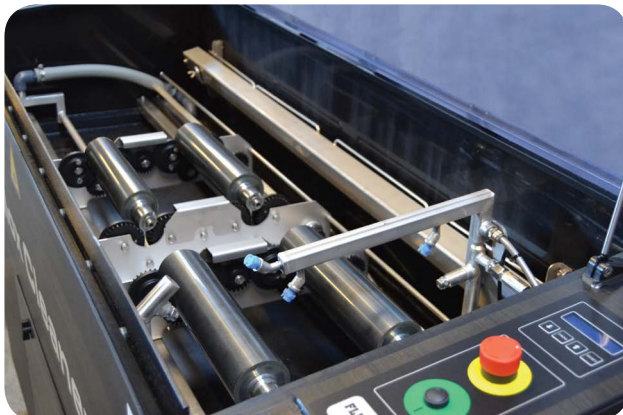
La FW Handy 2x2 puede lavar hasta 4 anilox de forma simultánea.
